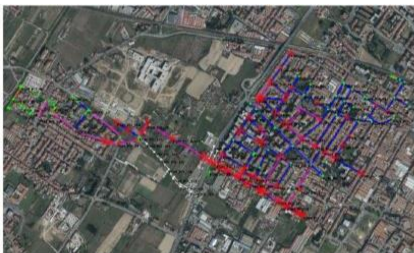
Figura 46: Funzionamento della rete fognaria per diversi tempi di ritorno. Le aree in rosso evidenziano pozzetti previsti con funzionamento in pressione. Fonte: Studio “Mitigazione allagamenti via San Paolo (Prato) - Campagna di monitoraggio,modellazione e valutazione di soluzioni mitigatrici”.
